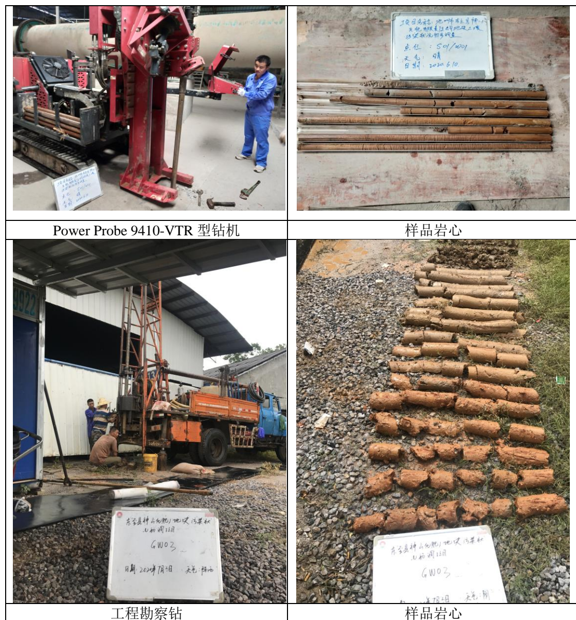
图 4.2-2 钻机现场取芯工作照片
