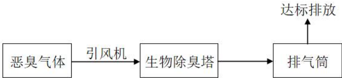
图 6.2.1-1 堆粪区除臭流程
