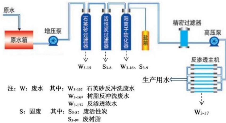
图 2.1-5 纯水制备工艺流程与产污节点图
