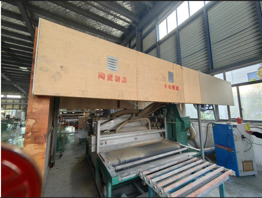
喷砂机未设置排气筒
