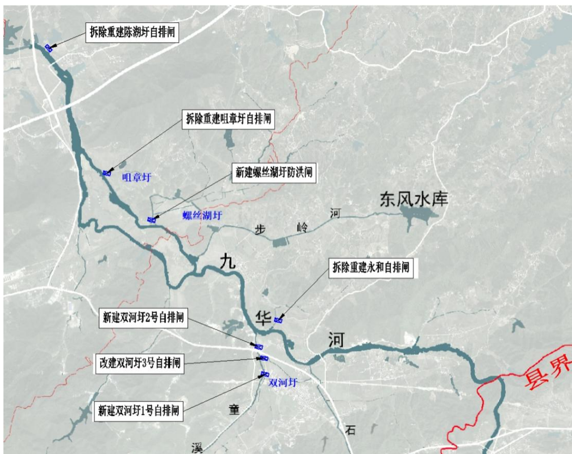
图 3.2-7 贵池区河段涵闸工程布置图
