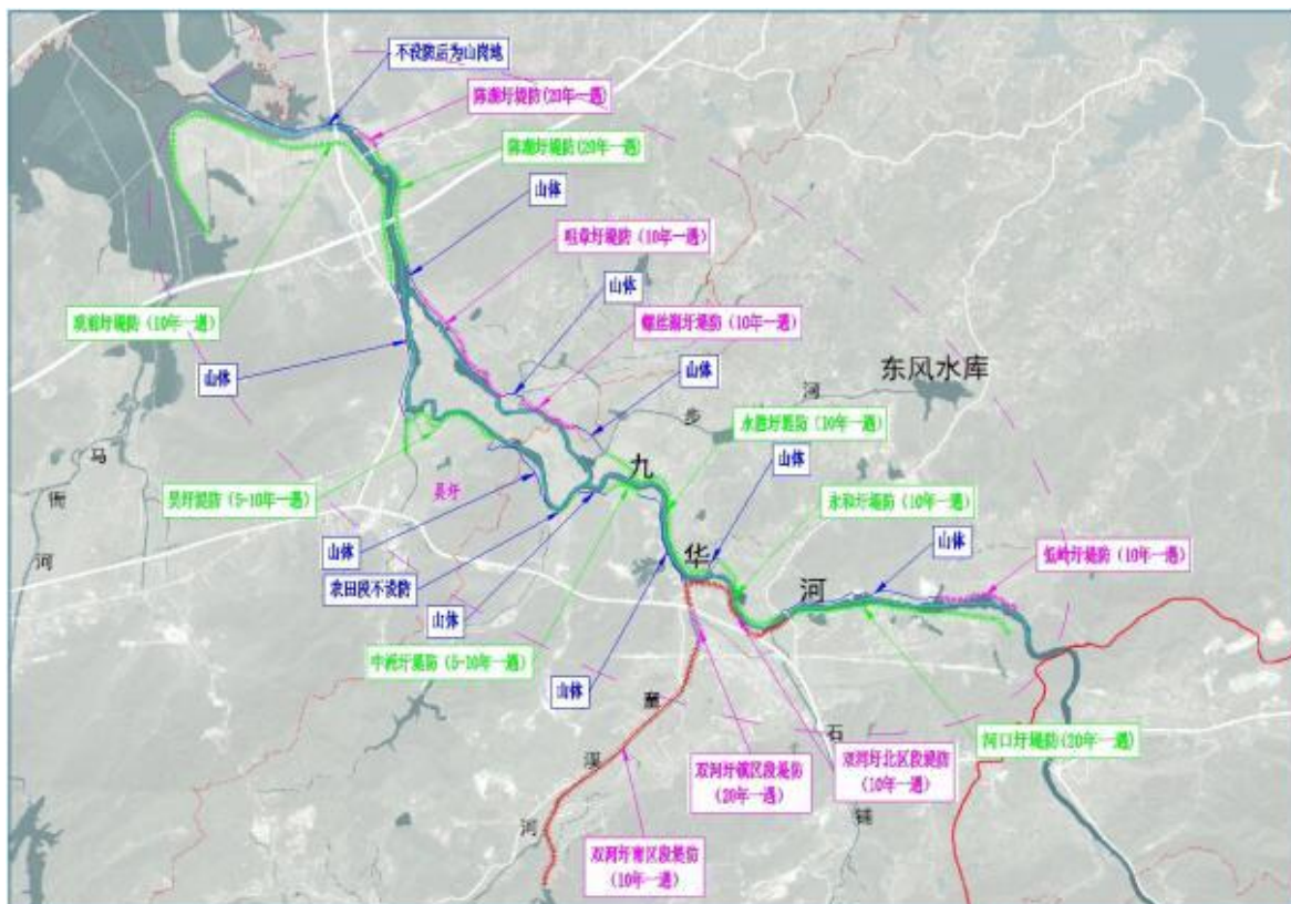
图 2-2 九华干流贵池区段防洪体系图
