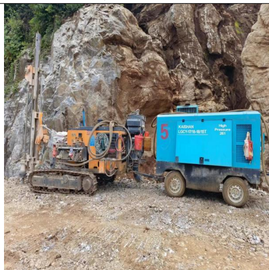
凿岩机（自带干式捕尘器）
