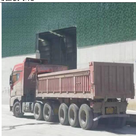
洒水车 and 运输车辆加盖帆布（伸缩式）
