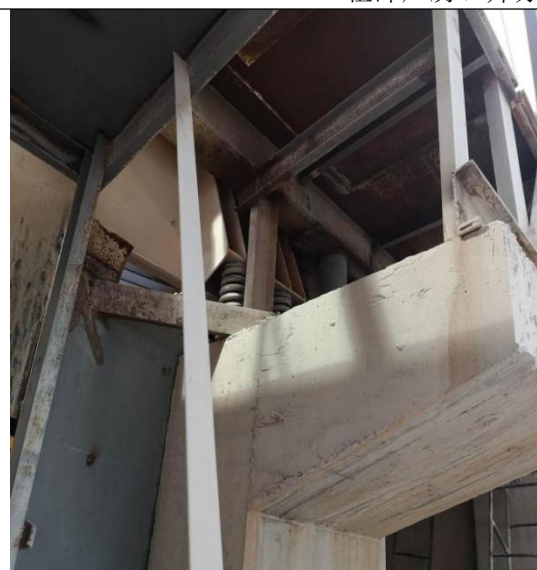
破碎机、振动筛基础减震设施（减震器、减震垫等）
