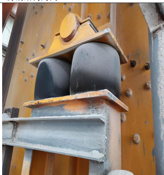
破碎机、振动筛基础减震设施（减震器、减震垫等）
