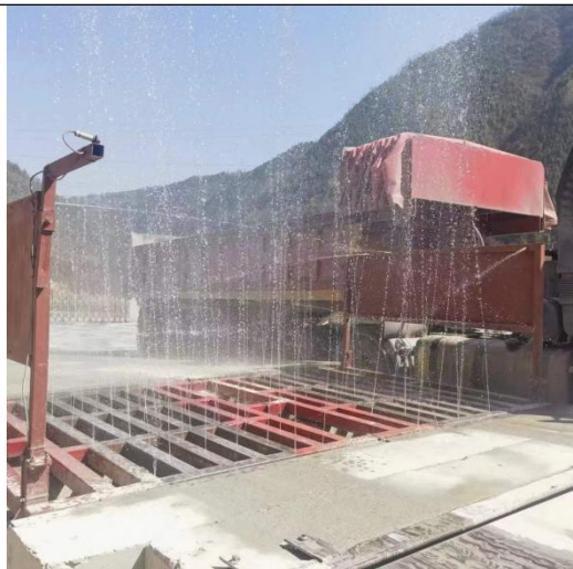
轮胎冲洗点和车辆冲洗站
