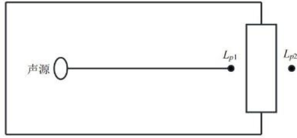
图 4-2 室内声源等效为室外声源图例
