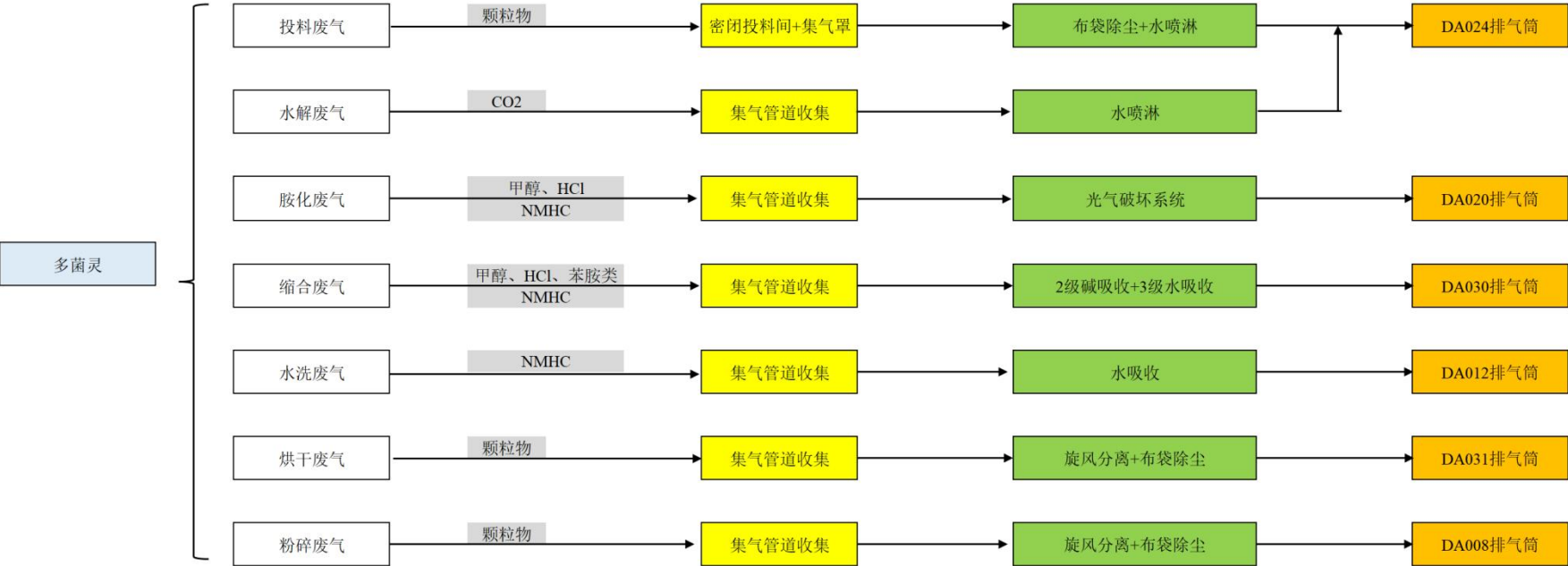
图 5.1.3-1 多菌灵项目废气收集处理废气收集处置情况示意图
