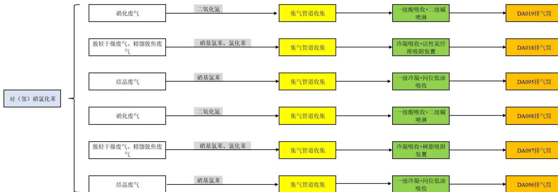
图 5.1.3-7 对（邻）硝基氯化苯项目废气收集处理废气收集处置情况示意图
