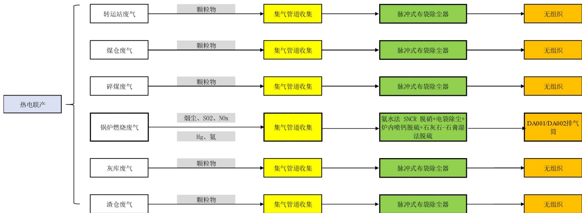
图 5.1.3-5 热电联产项目废气收集处理废气收集处置情况示意图
