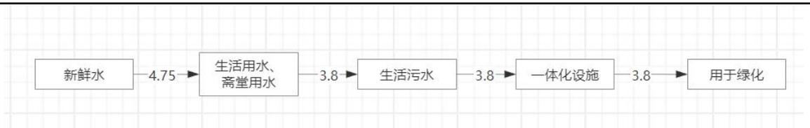
图 2-1 水平衡图 (t/d)
