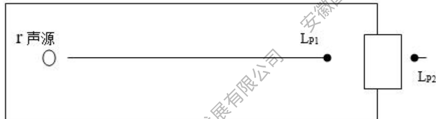
图 5.3-1 室内声源等效为室外声源图例
