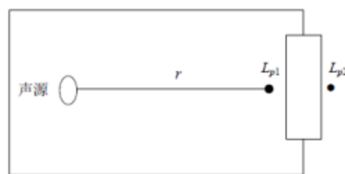
图 5.2.3-1 室内声源等效为室外声源图例
