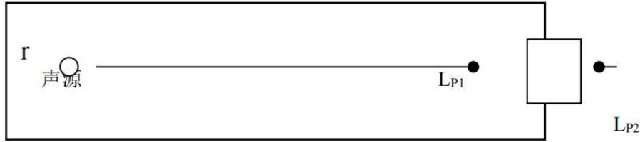
图 5.2.3-1 室内声源等效为室外声源图例
